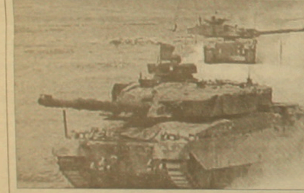
«Չելենջեր» հրասայլերն իրենց դժվար խոցելի գրահով, լազերային դեռեսկոտով եւ համակարգչային կառավարման գեներով համդիսանում են ամերիկյան ցամաքային ուժերի գլխավոր գեները:
